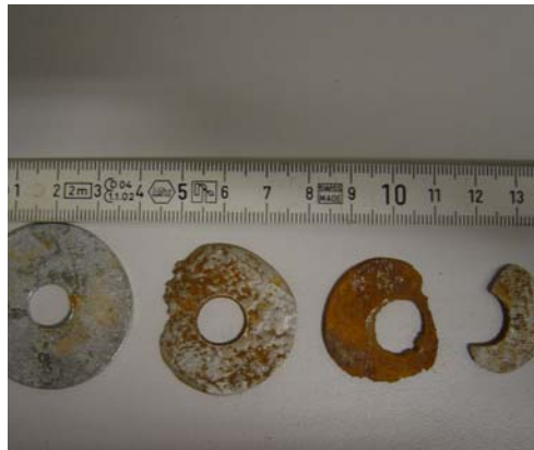
Abbildung 3: Entleerung Wasserfassung und Metallkorrosion
